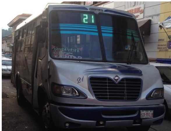
Figura 18. Vista de display de LEDs verdes, instalado.
