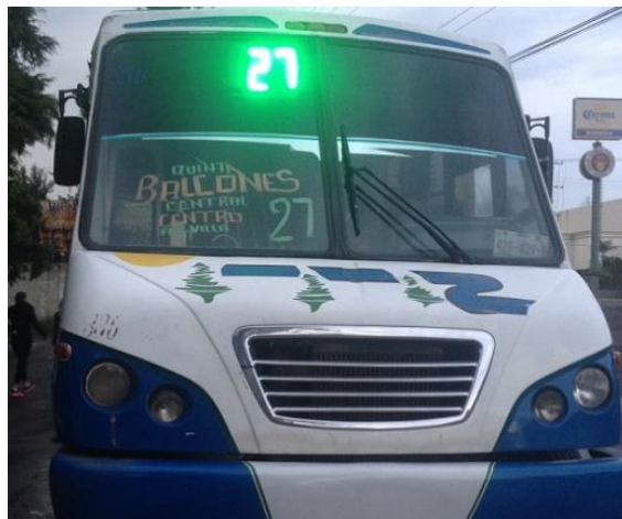
Figura 19. Vista de display de LEDs verdes, instalado.
