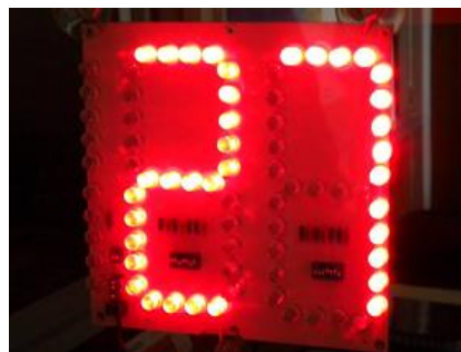
Figura 11. Display con dígitos de 32 LEDs de 10mm.
