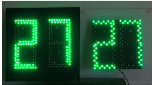
Figura 14. Displays con dígitos de 102 y 61 LEDs.
