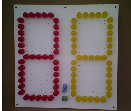
Figura 12. Display con dígitos de 39 LEDs de 10mm.
