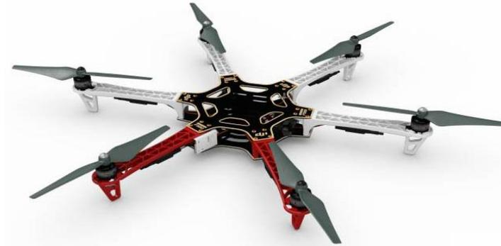
**Figura 2.** Estructura del hexacóptero.
