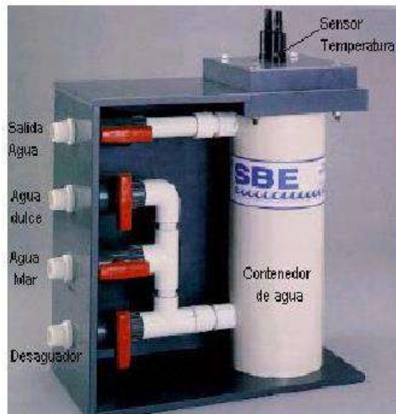
Figura 2. El Termosalinómetro SEACAT (SBE 21).
