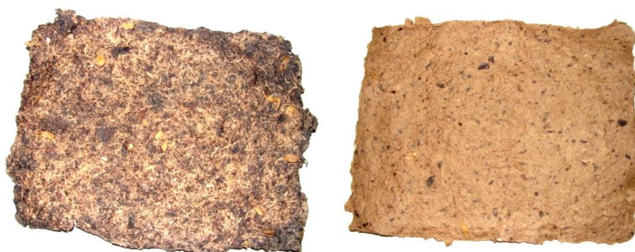
a) 100% pulpa de café encolado 2.5% interno y 2.5% externo b) 50% cartón + 50% pulpa de café encolado 2.5 interno y 2.5 externo
