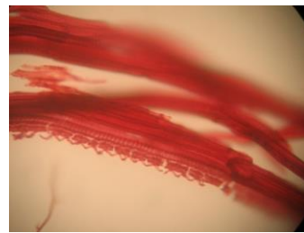
Fibras provenientes del proceso a la sosa a 40x.
