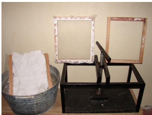
Figura 3.- Equipo para la elaboración de papel artesanal.
