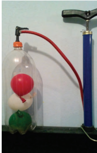
Figura 2.- Condición final de la botella, con los globos en su interior. Se hace notar la disminución de volumen en los globos, al introducirle aire a la botella.
