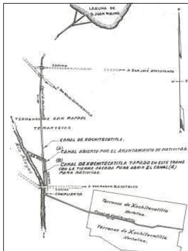
Figura 8. Infraestructura construida para la derivación del agua de riego superficial hacia los terrenos de cultivo, en San Miguel Xochitecatitla, 1931. Fuente: Archivo histórico del agua., D.F. 1931. Caja 1289, Foja 107.
