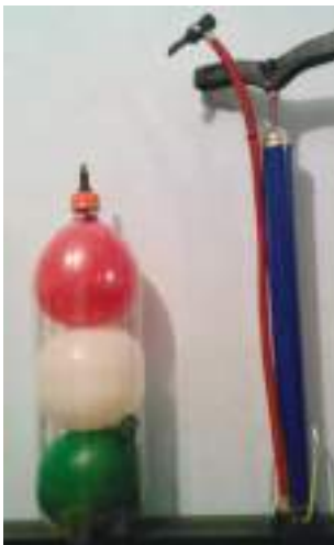
Figura 1.- Condición inicial de la botella, con los globos en su interior y compresor manual que se utilizará para introducirle aire a la misma.
