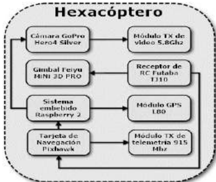
Figura 3. Diagrama a bloques de hardware integrado a hexacóptero.
