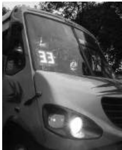
Figura 16. Vista de display de LEDs blancos, instalado.
