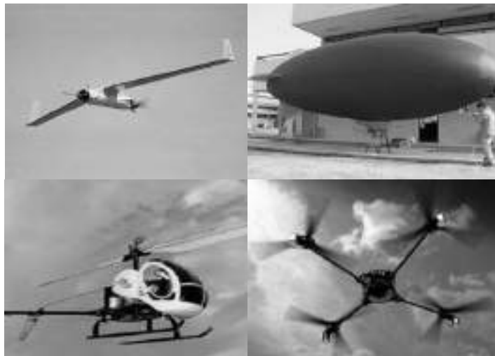
Figura 1. UAVs: a) Arriba-Izquierda: Aeroplano, b) Arriba-Derecha: Dirigible, c) Abajo-Izquierda: Helicóptero, d) Abajo-Derecha: Multirrotor.
