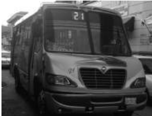
Figura 18. Vista de display de LEDs verdes, instalado.
