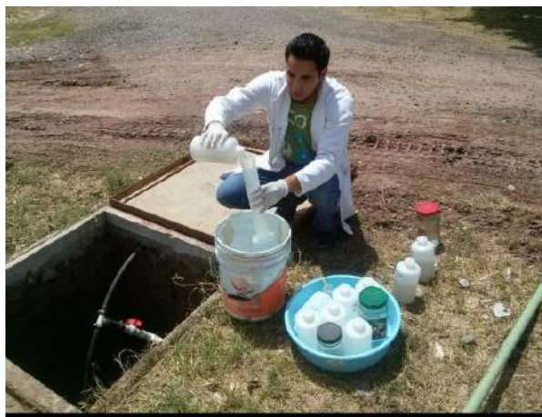
Figura 4. Toma de muestra de agua residual.
